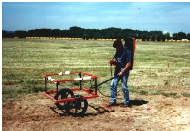
Abb. A-3.1 - 32: Metalldetektoren EM61 (Zwei-Spulensystem) und EM61-HH-MK2 der Firma Geonics.(Foto: Krummel)
