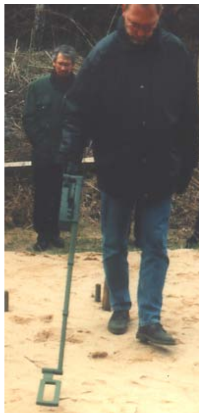
Abb. A-3.1 - 31: Metalldetektor MIMID der Firma Schiebel (Foto: Neumann)
