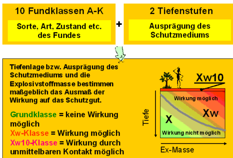
Abb. A-3.3 - 2: Die methodische Ableitung der Gefährdungsklassen aus den Fundklassen und den Tiefenstufen
