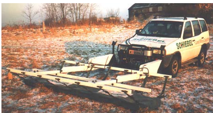
Abb. A-3.1 - 30: Fahrzeuggestützter Metalldetektor VAMIDS der Firma Schiebel (Foto: Neumann)
