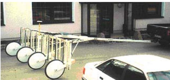
Abb. A-3.1 - 8: Fahrbares 8-Kanal-Aufnahmegerät von Sensys mit GPS (Foto: Neumann)
