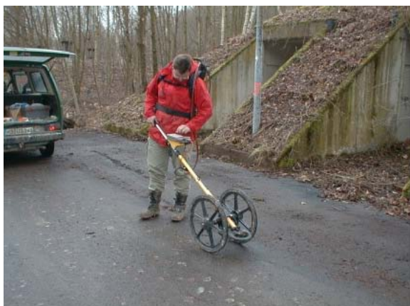
Abb. A-3.1 - 32: Metalldetektoren EM61 (Zwei-Spulensystem) und EM61-HH-MK2 der Firma Geonics.(Foto: Krummel)
