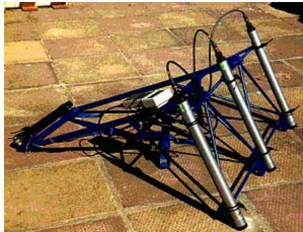
Abb. A-3.1 - 7: Tragbares 3-Kanal-Aufnahmegerät von Sensys, auch mit GPS verwendbar (Foto: Neumann)
