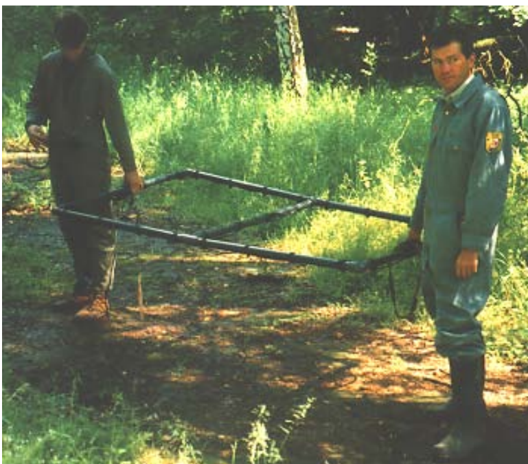
Abb. A-3.1 - 28: Großschleife UPEX 740 der Firma Ebinger (Foto: Neumann)
